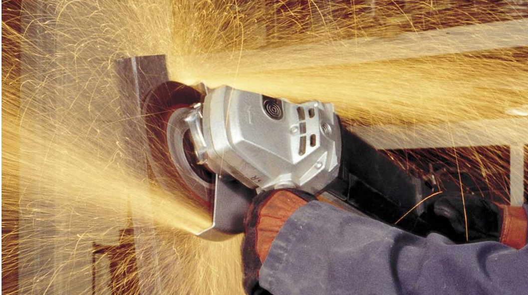
Figura 10 – Esmerilhamento utilizando disco abrasivo de desbaste de óxido de alumínio Fonte: WALTER TECNOLOGIAS EM SUPERFÍCIES. Disponível em: http://www.walter.com/pt_BR/produtos/abrasivos/desbaste/hp-xx . Acesso em: 06 jul. 2015.
