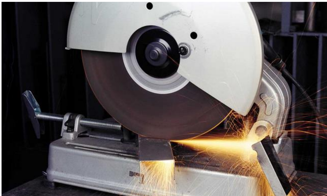
Figura 9 – Corte utilizando disco abrasivo de corte de óxido de alumínio
